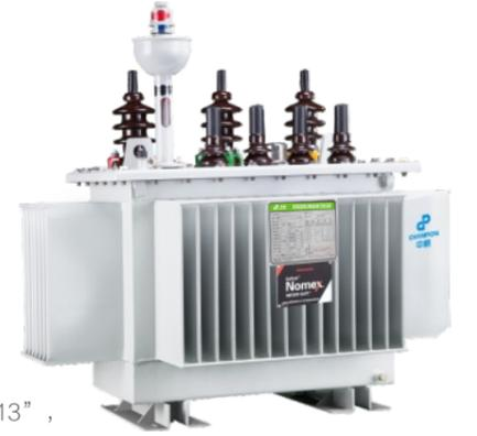
示例: 一台三相、油浸、自冷、双绕组、无励磁调压、绝缘耐热等级为F级, 损耗水平代号为“13”, 额定容量为100kVA的10kV电压等级全密封式耐高温高过载变压器型号表示为: S13-M(F)-100/10GZ。
