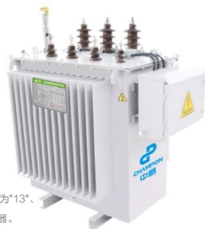
示例: SZ13-M · ZT-400 (125) /10, 表示一台三相、油浸、自冷、双绕组、损耗水平代号为“13”、全密封、大容量为400kVA、小容量为125kVA、额定电压为10kV的有载调容调压变压器。
