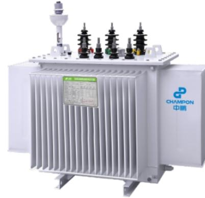
示例：一台三相、天然酯、自冷、双绕组、无励磁调压、绝缘耐热等级为B级，损耗水平代号为“13”，额定容量为100kVA的10kV电压等级全密封式耐高温植物油配电变压器型号表示为：SW(B)13-M-100/10
